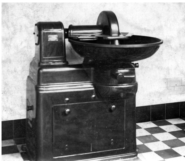
Obr. 18/ Elektrokutr, č. K820. Zhotovila Strojírna Bruna, nákupního, prodávajícího a výrobního družstva Moravských řezníků a uzenářů, Brno. Fotoalbum, 20.-30. léta 20. století. Sbíрка TMB, 02.03-67.
