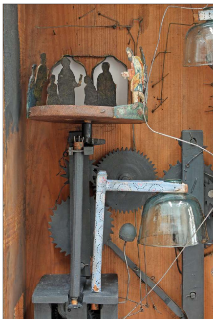
Obr. 8 Detail umístění dřevěného kotouče v orlojové skříni – pohled ze zadní strany / Detail of the placement of a wooden wheel in an astronomical clock case – view from the back
