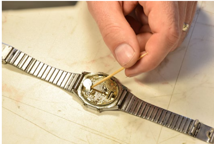
Obr. 2: Vyjmutí baterie pomocí dřevěného páráčka
