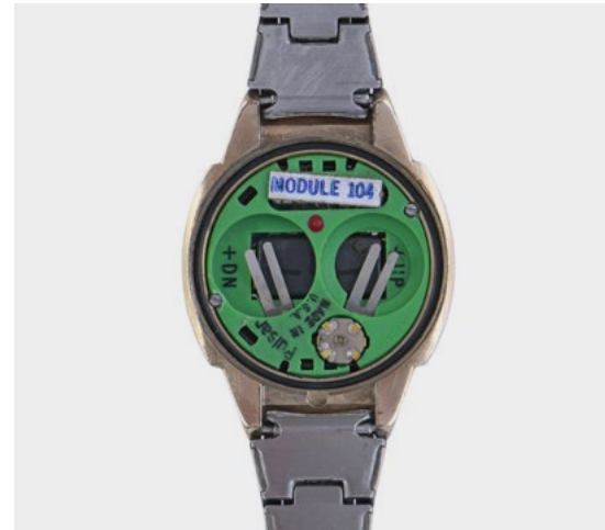
Obr. 3: Digitální hodinky Pulsar Time Computer, inv. č. 21.60-00325C, zadní strana po odstranění krytu a baterií
