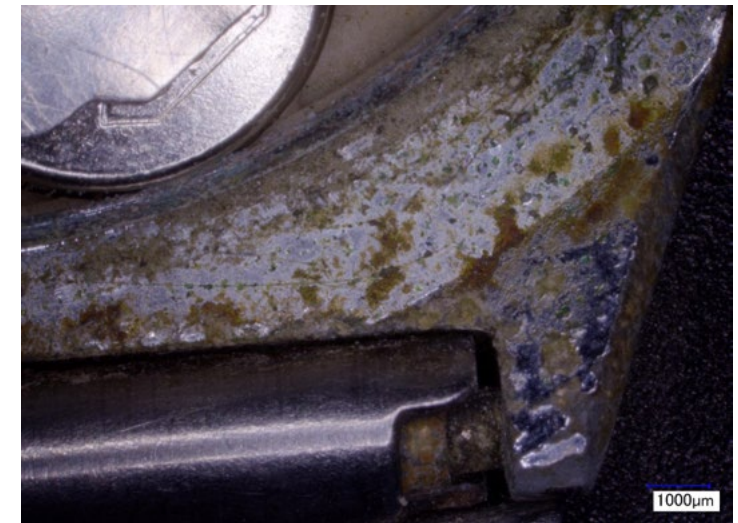
Obr. 1: Mikroskopický snímek detailu korozního poškození vnitřní obruby digitálních hodinek
